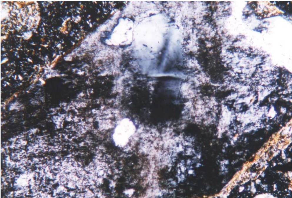
Figura 42. Muestra 2 de micromorfología de suelos. Grano de cuarzo con matriz silíceo. Las fracturas muestran una etapa de compactación de los materiales (50 X).
